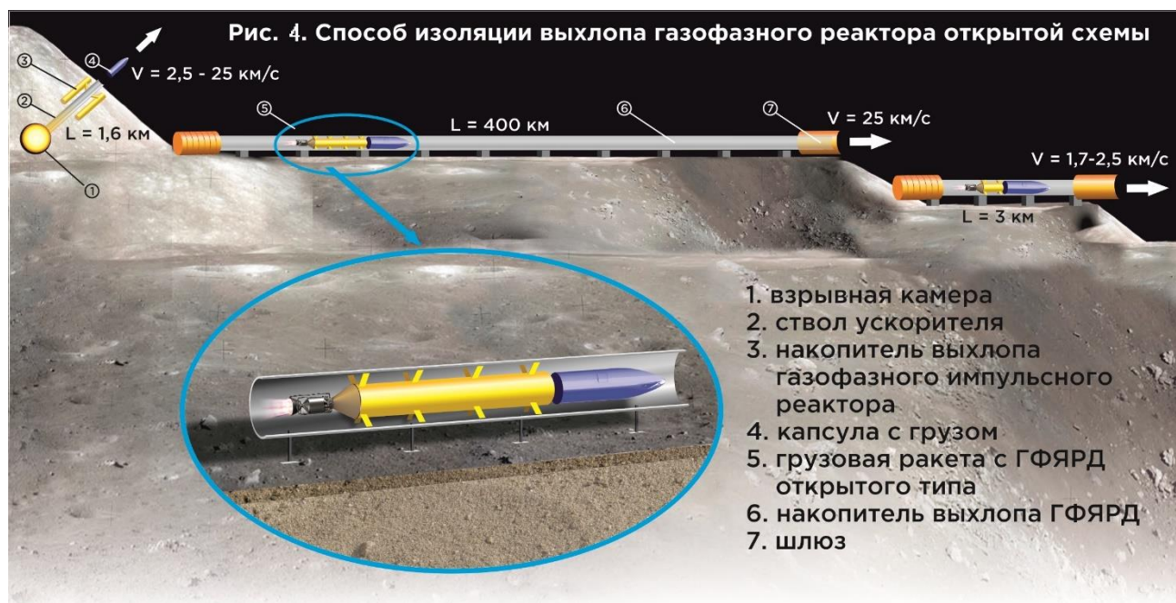
Рис. 4. Невзрывная транспортная технология – запуск грузовых кораблей с газофазным ядерным ракетным двигателем открытой схемы. Способ изоляции и накопления выхлопа газофазного реактора открытой схемы.
