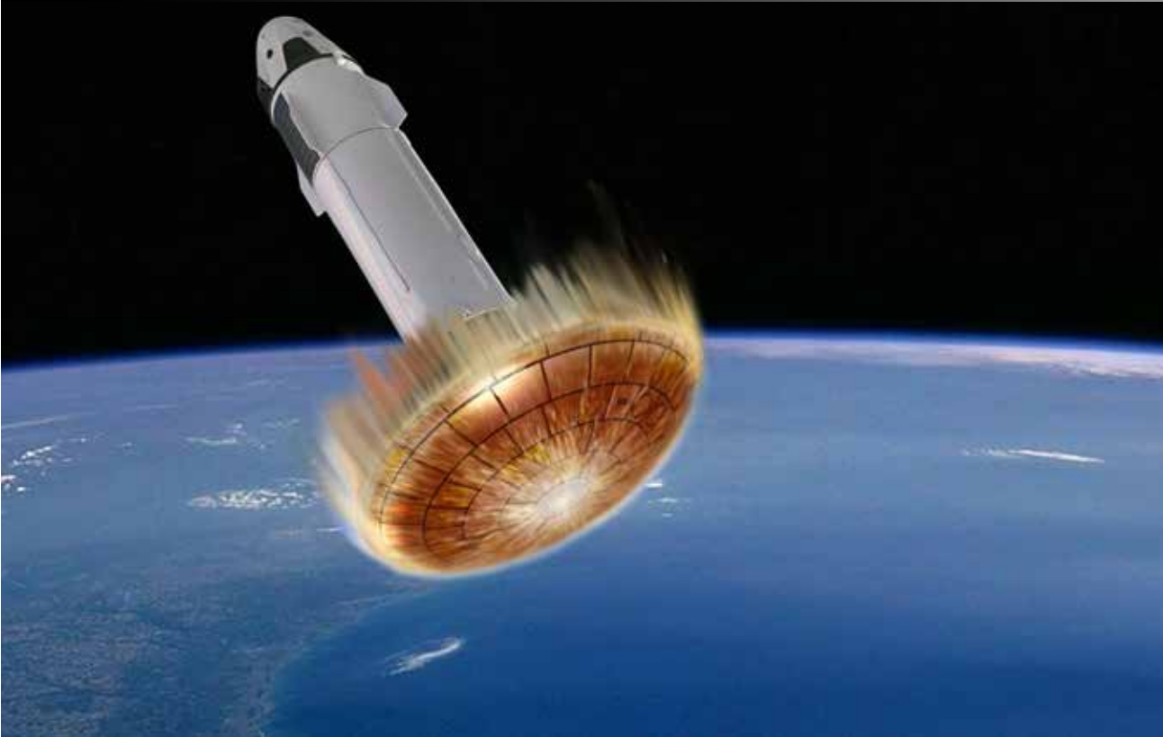
Рис. 1. Возвращение второй ступени РН Falcon 9 при помощи донного теплозащитного экрана, присоединяемого к ступени после старта на орбите
